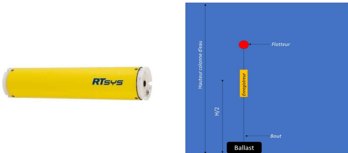
Figure 6 : Enregistreur acoustique Sylence et schéma de déploiement.
