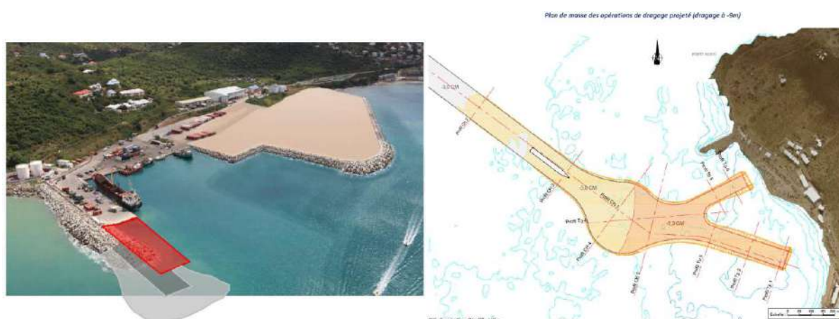
Figure 1.1 : Le projet d'aménagement et d'extension du Port de Commerce de Galisbay, esquisse SETEC (à Gauche) et le plan masse des opérations de dragage pour un chenal à -9m (à droite).
