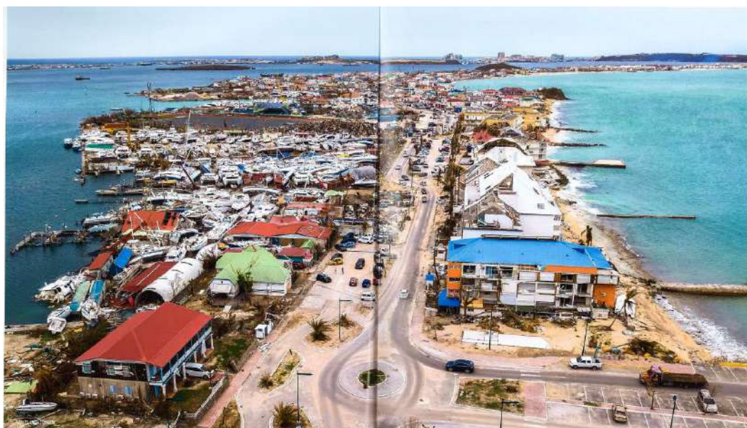
Figure 5.23 Marigot après Irma. La rue de Sandy Ground à l'entrée de Marigot a été submergée. La mer à droite est passée par-dessus la route et les constructions pour rejoindre le lagon sur la gauche (Réf. /10/).
