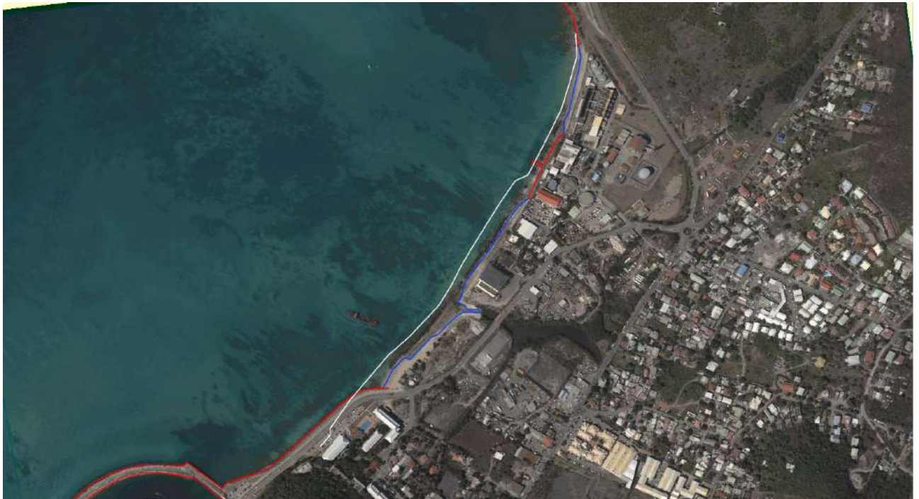
Figure 5.11 Photographie aérienne (IGN) de février 2010 de la plage de Galisbay. Trait de côte 1969 (blanc) et trait de côte février 2010 (rouge et bleu).
