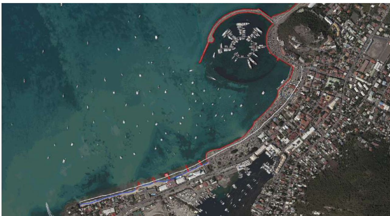
Figure 5.9 Photographie aérienne (IGN) de 2010 du secteur Plage de Marigot – Marina Fort Louis. Trait de côte 1969 (blanc) et trait de côte février 2010 (rouge et bleu).
