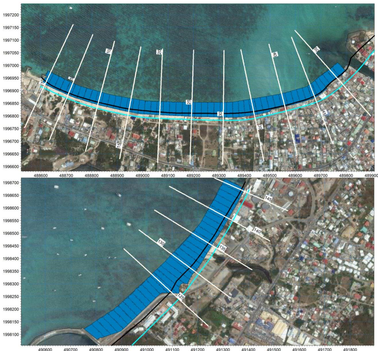
Figure 7.5 La carte maille/section relie le régime d'érosion/dépôt des éléments 2D aux sections du modèle côtier. Les mailles qui ne sont pas reliées au modèle côtier ne sont pas présentées. La ligne de référence (en cyan) et le trait de côte initial de 2019 (en noir) sont également présentés.
