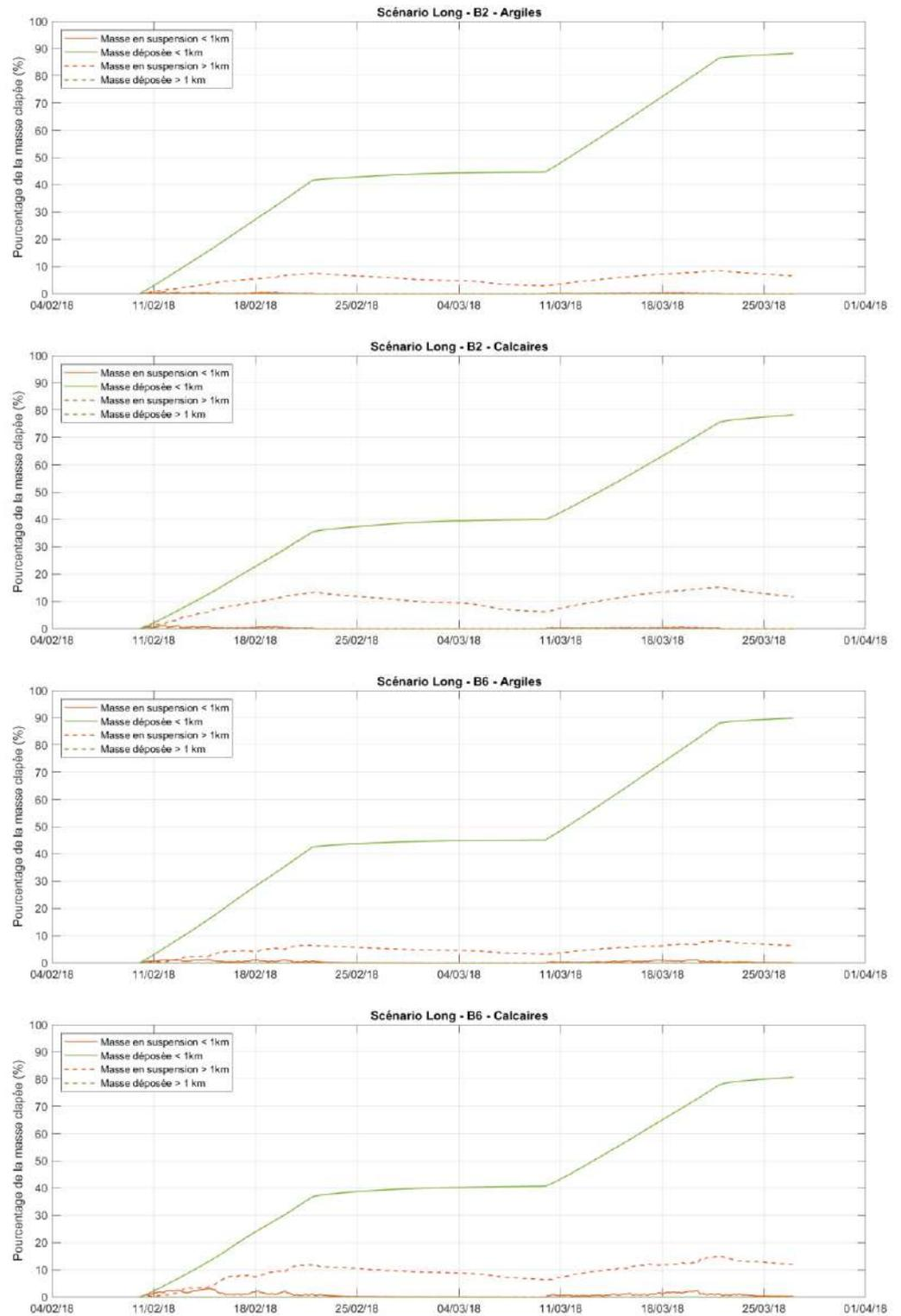
Figure 6-90 : Pourcentage de la masse totale clapée en suspension et déposée, dans un rayon de 1 km autour du point de clapage et au-delà – Scénario long.
