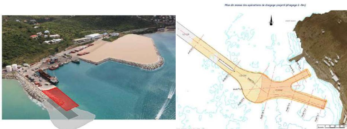
Figure 1-1 : Le projet d'aménagement et d'extension du Port de Commerce de Galisbay, esquisse SETEC (à gauche) et le plan masse des opérations de dragage pour un chenal à -9m (à droite).
