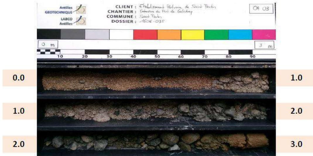
Figure 3-10 : Photographie des sables marins superficiels présents dans les échantillons du sondage carotté de 0 à 3m (soit de -4.5 à -7.5 m NGG) au point Ca3 (Réf. /3/).
