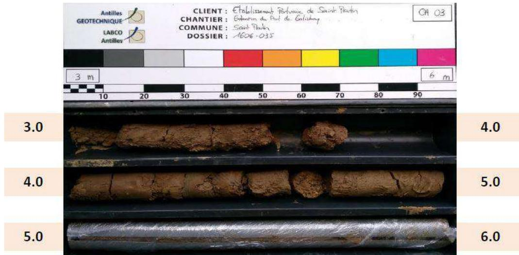
Figure 3-11 : Photographie des argiles indurées présentes dans les échantillons du sondage carotté de 3 à 6m (soit de -7.5 à -10.5 m NGG) au point Ca3 (Réf. /3/).
