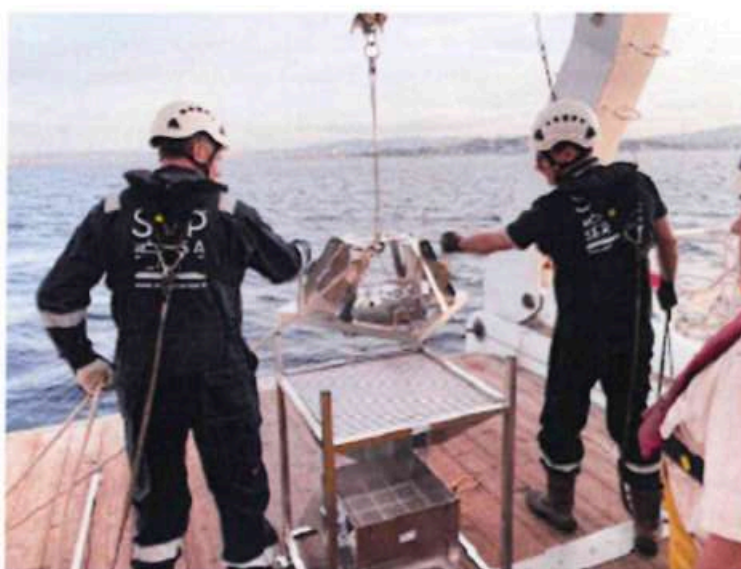
Figure 44 : Prélèvements du benthos à la benne Day par 600 m de fond au large du Marco (Source GTB, 2022)
