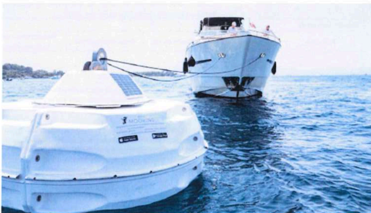
Figure 37 : Exemple d'un mouillage Doria Mooring, bouée connectée, à Èze (Source Marine Nationale, 2022)
