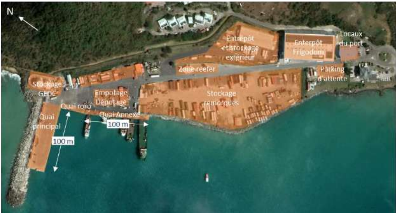
Fig.1. Description des espaces fonctionnels du port de Galisbay (source : See'Up, Etablissement portuaire de St-Martin)
